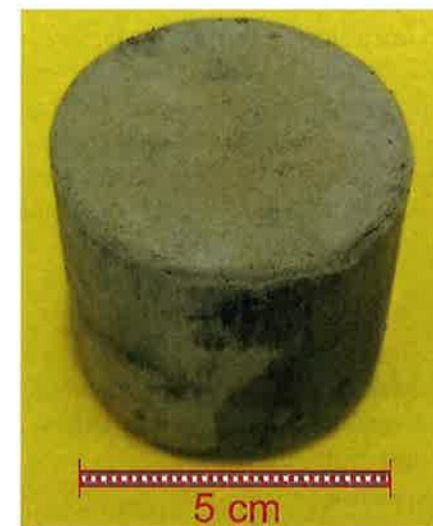
Die Brikettierung von Mineralwollabfällen ist eine mögliche Option für die platzsparende Deponierung. In ersten Versuchen konnte die Dichte um über Zehnfache auf 2.000 kg/m 3 erhöht werden.
