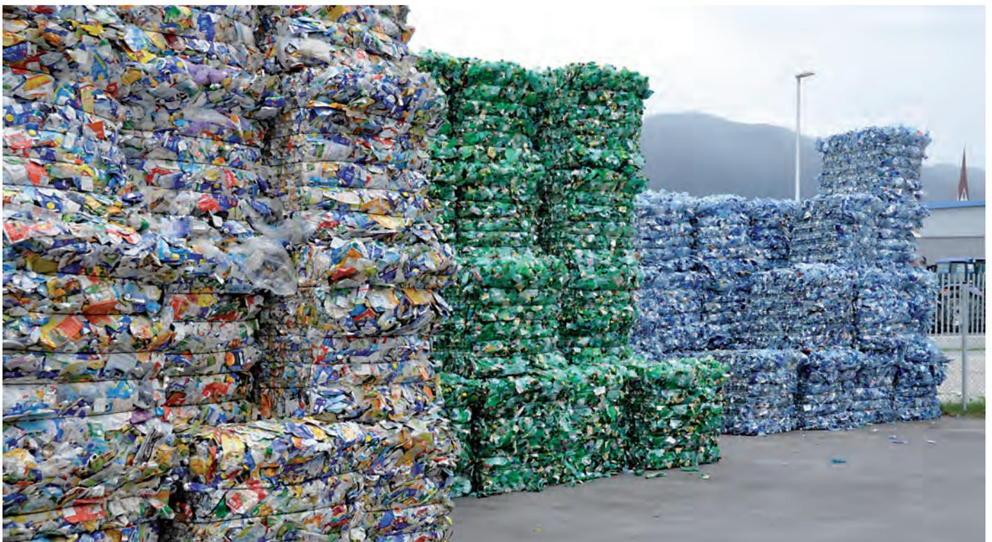
Sortierte, stofflich verwertbare Kunststoffabfälle (PET) und Verbundkartons (kunststoff-laminiertes Kartonmaterial)
