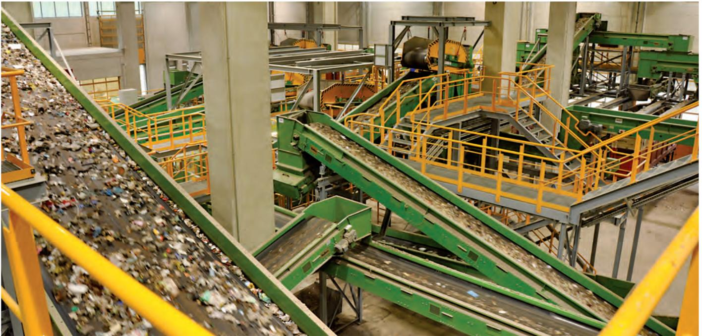
*Mechanische Aufbereitung und Sortierung von Abfällen, vollautomatische Steuerung und Prozessführung*
